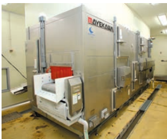
ベルトを振動させながら風を当てパラ パラに凍結できるラインフリーザー。
