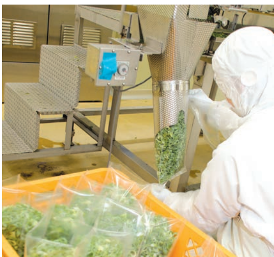
カット後、バラバラの状態でも凍され袋詰めされる九条ねぎ。金属探知と計量は同時に行われている。
