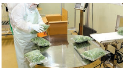
カット後、バラバラの状態でも凍され袋詰めされる九条ねぎ。金属探知と計量は同時に行われている。
