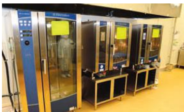
真空適温調理で欠かせない、加熱処理用の「スチームコンベクション」。他にも調理過程に応じた大型機械が並ぶ。
