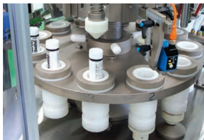
歯磨きペーストの製造工場。容器が破損していないか厳しく検査しながら製品を完成させていく。
