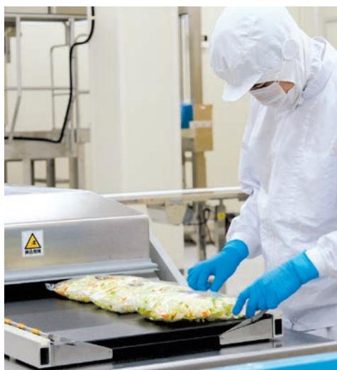
パッケージ作業は一部機械を使用するが、人の目と手でもつぶさに確認し、異物混入などを徹底的に防ぐ。
