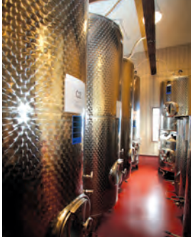
密閉性が高く、ブドウの酸化を防ぐステンレスタンク。味や香りに個性が出やすい木樽と使い分け、ブドウの品種に適した熟成を行う。
