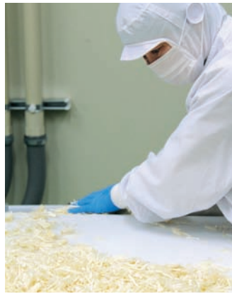
手作業で株元を切り離した後、機械でさらに細かくカットし3センチ規格に揃える。
