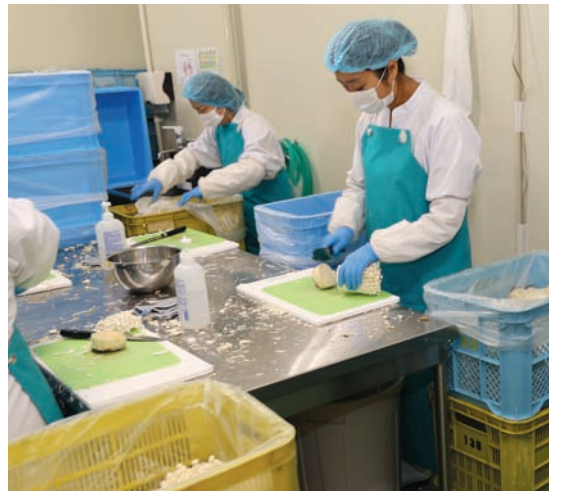
手作業で株元を切り離した後、機械でさらに細かくカットし3センチ規格に揃える。
